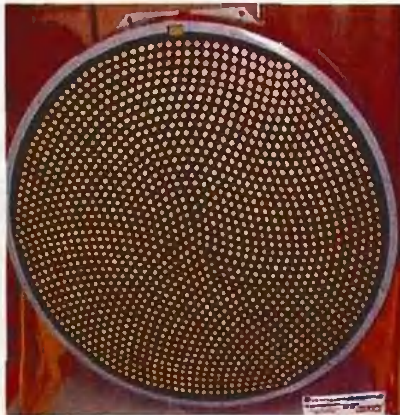
Такая антенна скрывается за носовым обтекателем современного истребителя.
