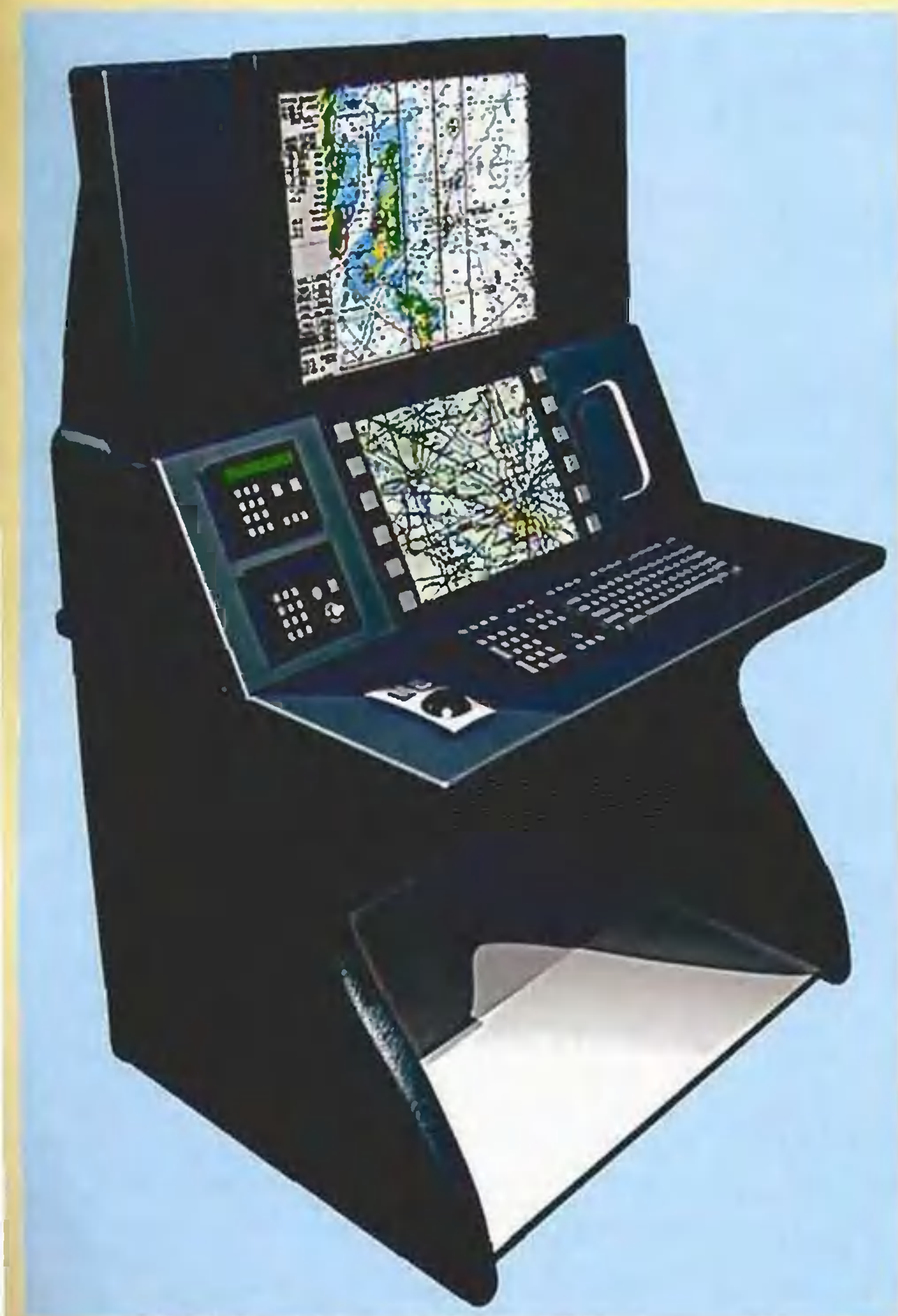
Пульт оператора бортового радиолокационного комплекса.
