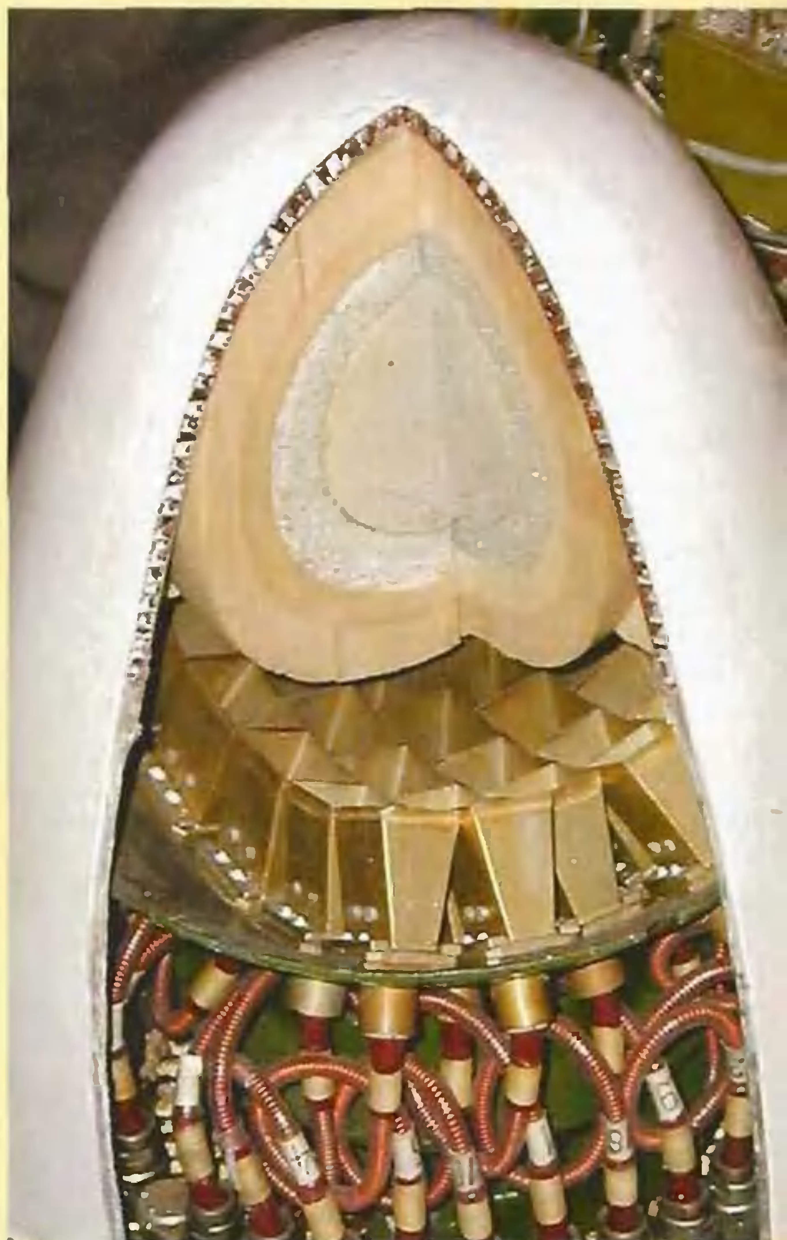
Антенная система станции, создающей помехи радиолокаторам противника.
