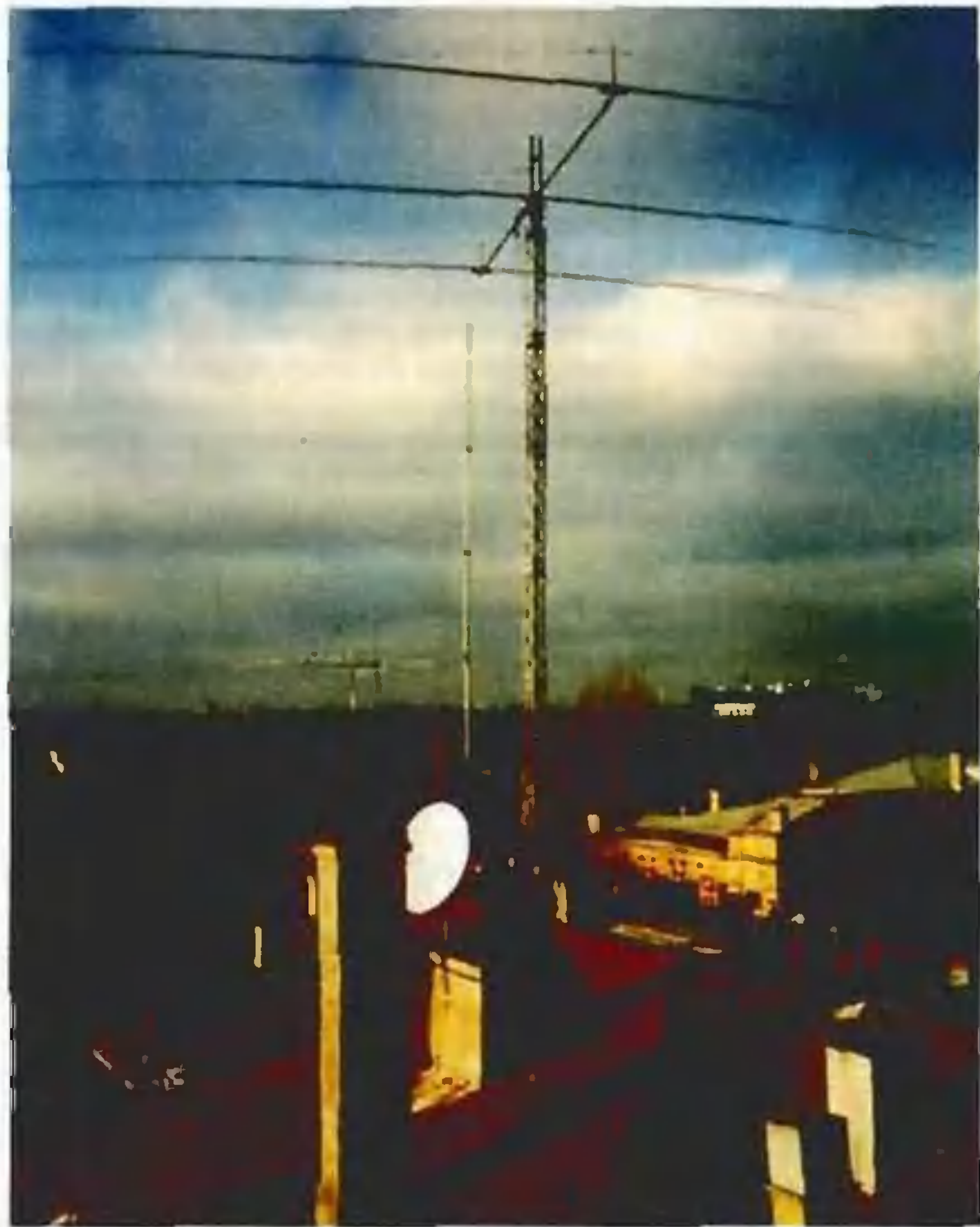
Гордость коллектива RZ1AWO — трехэлементный "волновой канал" для диапазона 40 метров.
