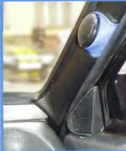
Две ВЧ головки расширяют диаграмму направленности
