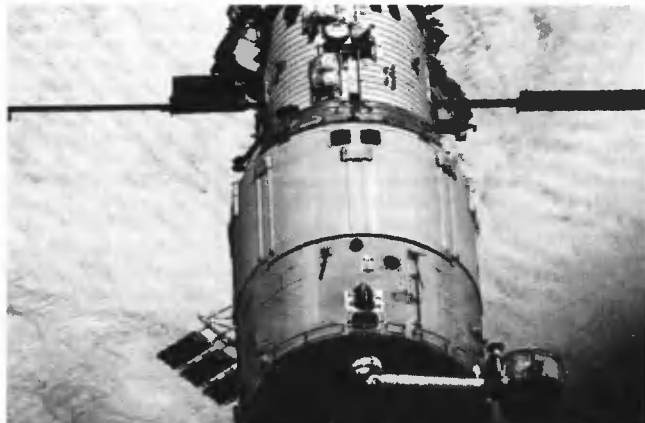
Вот так выглядят радиолубительские антенны на борту. Справа внизу — рядом за служебной параболической антенной связи видна антенна на диапазон 10 метров, а на три часа влево находится штырь на 2 метра. Остальные две антенны двухметрового диапазона располагаются на диаметрально противоположных сторонах обшивки корпуса.
