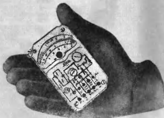
Рис. 4. Миниатюрный авометр т. Бортновского
