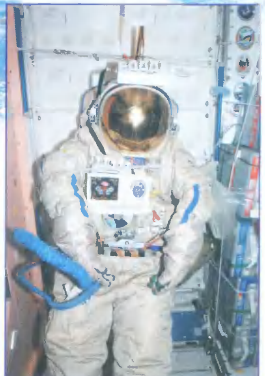
Экипаж МКС монтирует на шлеме скафандра пульт управления и антенну радиопередатчика.
