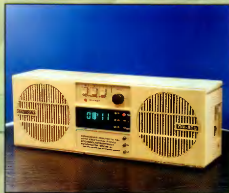
Трехпрограммный громкоговоритель с расширенными функциональными возможностями — встроенные цифровые электронные часы, таймер для автоматического включения и отключения. Псевдостерео, выходная мощность — 1 Вт. 1990-е годы.
