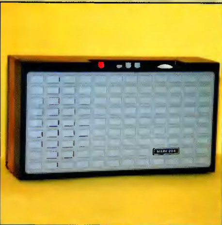
Трехпрограммный громкоговоритель 2-й группы сложности. Усовершенствованная звуковая головка позволяла добиться лучшего качества звучания. 1990-е годы.
