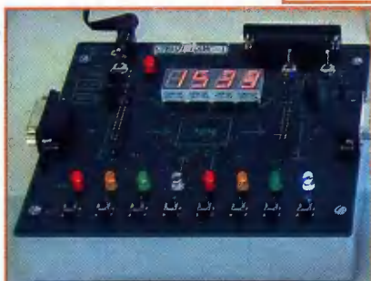
Учебный лабораторный стенд "ПЛИС-1".
