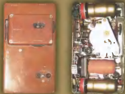
Приемник радиостанции «БЕЛКА» собран на двух лампах.
