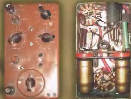
Передатчик радиостанции «БЕЛКА» собран на двух лампах.
