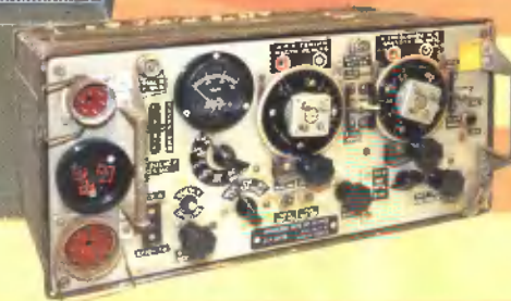
Wireless Set No. 19 Mk II — танковая и общевойсковая КВ и УКВ радиостанция. Диапазоны частот: КВ 2...8 МГц (два поддиапазона) для дальней связи со штабами и УКВ 229...241 МГц для ближней связи между танками. Виды работы — ТЛГ и АМ. Выходная мощность до 5 Вт (на КВ телеграфом) и 0,4 Вт (УКВ).
