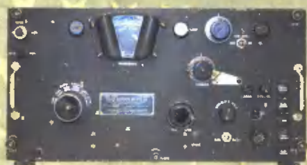
BC-312-NX — общевойсковой КВ приемник. Диапазон частот 1,5...18 МГц, виды работы — ТЛГ и АМ, кварцевый фильтр. Входил в состав мобильных комплектов SCR-399 и SCR-489, которые поставлялись в СССР по ленд-лизу.
