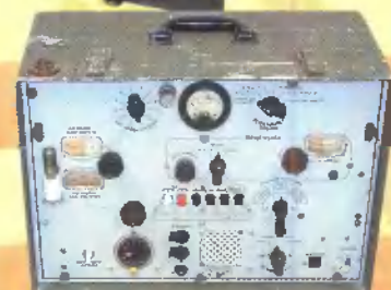
V-100-B — переносная общевойсковая КВ радиостанция. Диапазон частот 3...7 МГц. Передатчик имел также четыре фиксированные частоты, стабилизированные кварцем. Виды работы — ТЛГ и АМ. Выходная мощность в режиме ТЛГ — 15 Вт, в режиме АМ — 5 Вт. Все надписи на передней панели выполнены на русском языке.
